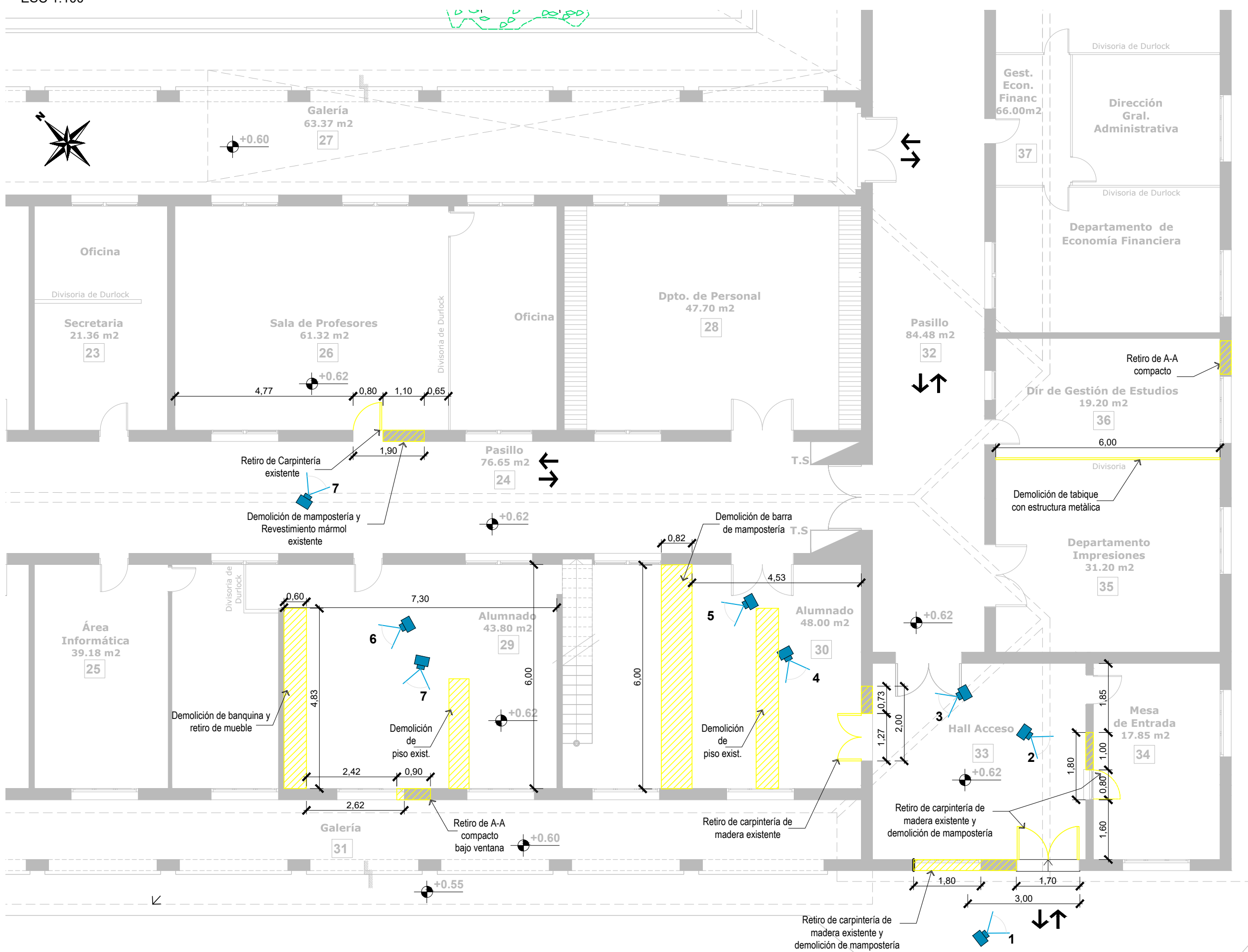
PLANO DE RELEVAMIENTO Y DEMOLICIÓN - FAC. CIENCIAS ECONÓMICAS SECTOR A INTERVENIR - PLANTA BAJA ESC 1:100
